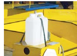
消毒液タンク
