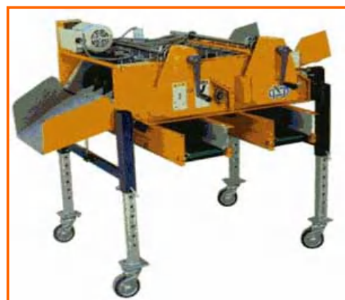
ノブタ農機の種イモ形状選別機「サイザー」。手前に見えるハンドルを回すことで落下させる種イモのサイズを容易に調整できる。
